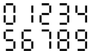
Отображение цифр на 7-сегментном индикаторе
